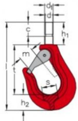
Le crochet à tige ne doit être utilisé que sous charge verticale.
