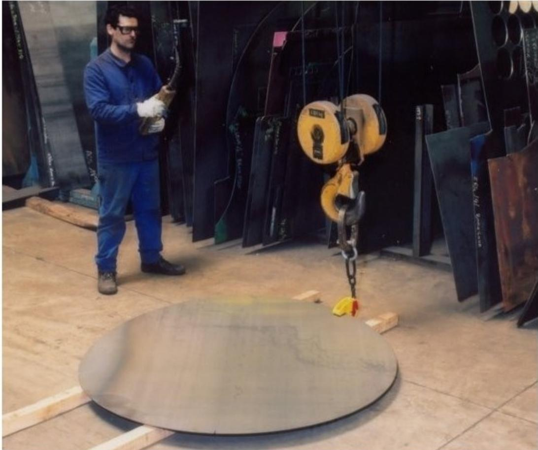
*Fonction levage* : ne pas dépasser l'angle admis de 15° entre la chaîne et le plan des flasques.
