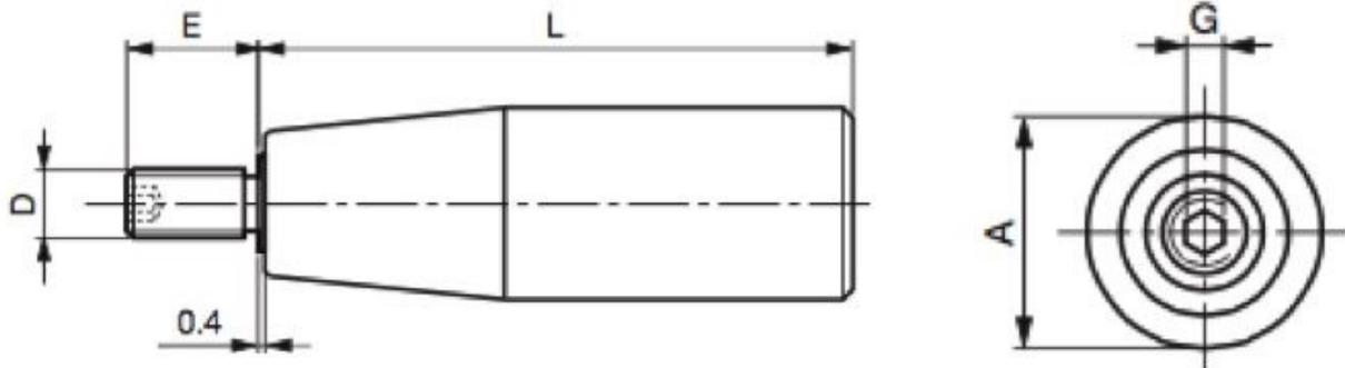
Axe fileté en acier inoxydable avec empreinte creuse hexagonale de blocage.
