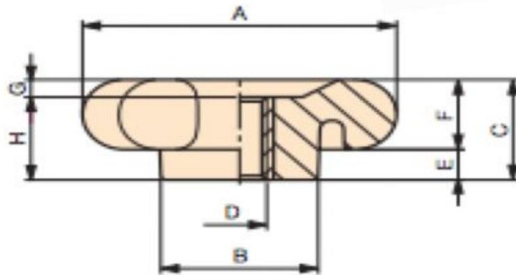
Insert en laiton traversant taraudé.
